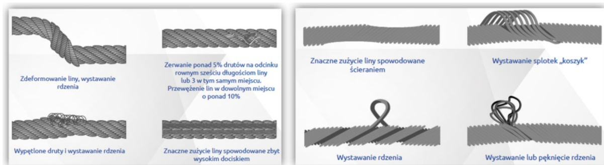
Rysunek 21 Zawiesia linowe – znamiona uszkodzeń
